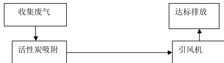
图 4-1 除臭系统工艺流程图
